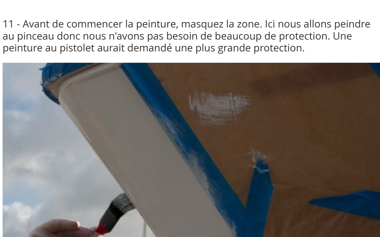
Réparer une rayure dans du gelcoat
