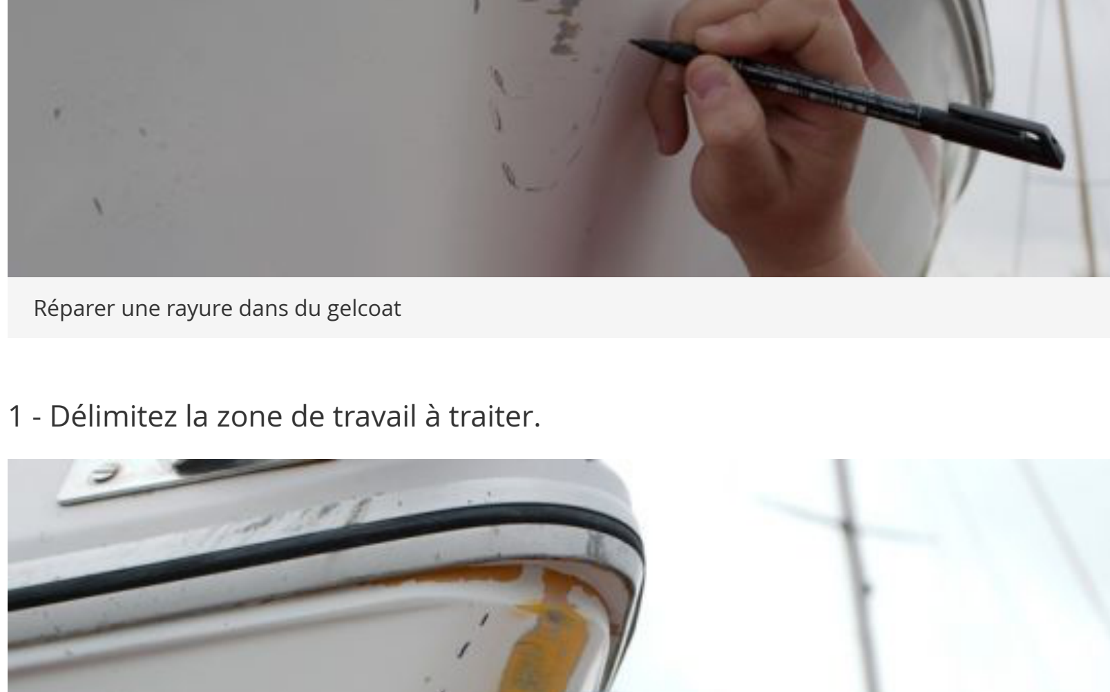
Réparer une rayure dans du gelcoat
