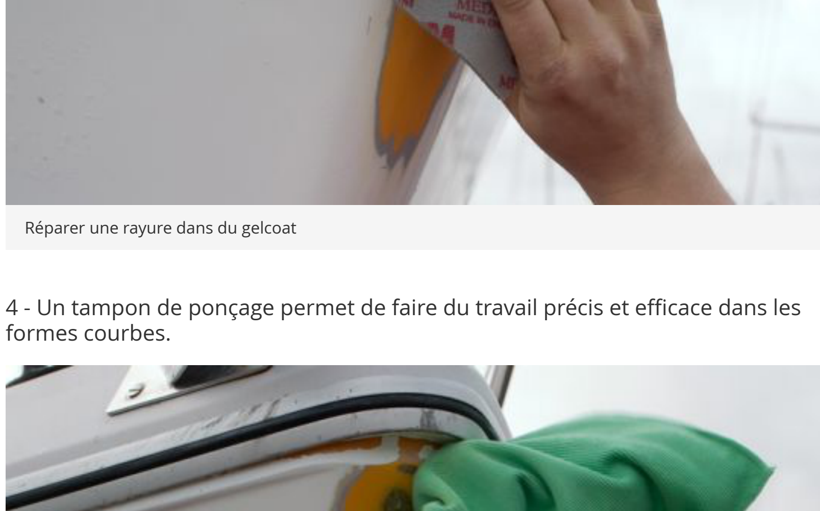
Réparer une rayure dans du gelcoat
